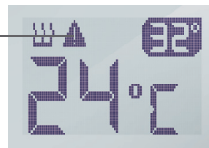
Рис. 5 Индикация в режиме контроля состояния системы обогрева
