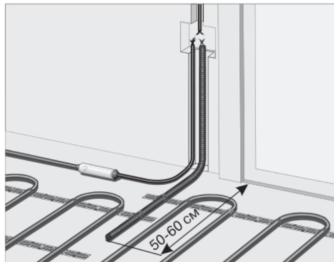
**Рис.45** Монтаж датчика температуры пола
