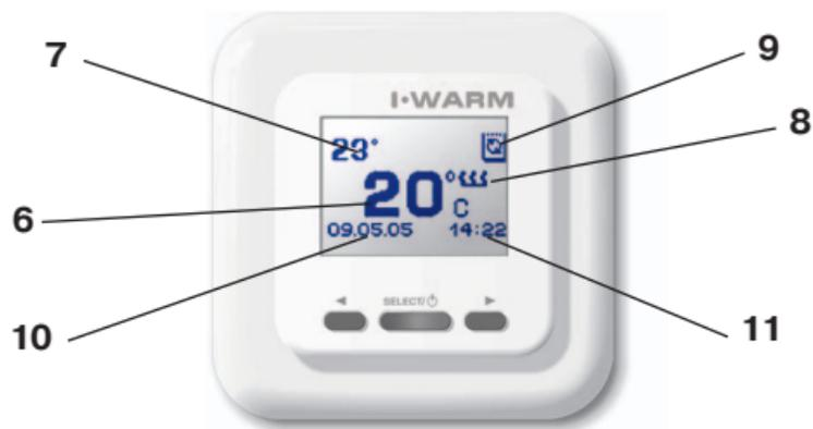
**Рис.3** Главная индикация в основном режиме работы
