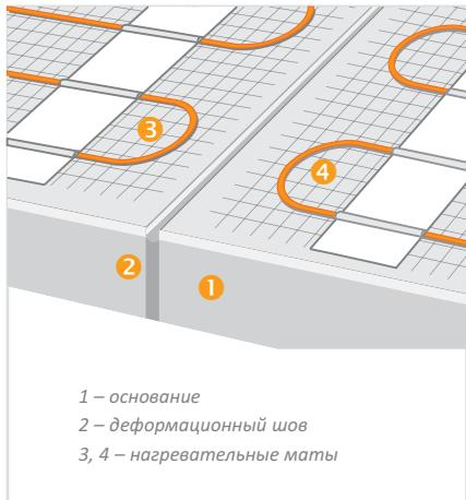
В случае, если здание имеет термокомпенсационные швы, нагревательные маты тонкого теплого пола ТЕПЛОЛЮКС должны быть расположены так, чтобы исключалась всякая возможность прохождения кабеля нагревательного мата через шов.
